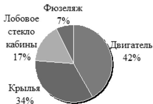
Рис. 3. Повреждения ВС Ту-154 и Ту-204 при столкновениях ВС с птицами за 2003-2011 гг.
